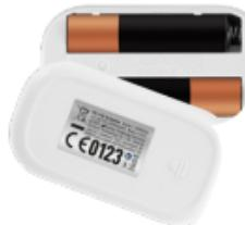
Jakmile na displeji začne svítit symbol slabé baterie, je jejich kapacita nedostatečná a je třeba je vyměnit. Do prostoru pro baterie vložte dvě suché baterie AAA, dbejte přitom na správnou polaritu +/- a nasadte kryt prostoru pro baterie.
