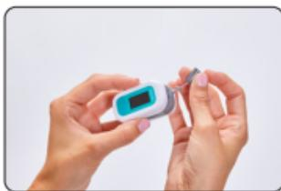
K jednoduššímu přenášení pulzního oxymetru můžete k přístroji připevnit poutko. Vložte úzký konec smyčky do otvoru v zářízení dle obrázku. Nyní protáhněte silný konec smyčky úzkým koncem a poté smyčku utáhněte.
