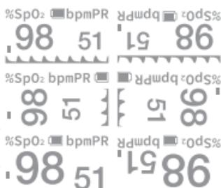
Hou de aan/uit-knop ingedrukt in het surveillanceproces. De bewaakte gegevens en de weergavemodus worden op twee verschillende manieren cyclisch weergegeven op het OLED-scherm (tekst en grafiek) en in vier richtingen, zoals afgebeeld in de volgende figuur.
