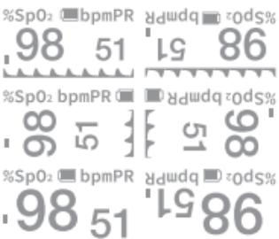
Betätigen Sie den Ein-/aus-Schalter im Rahmen des Überwachungsverfahrens kontinuierlich. Die erfassten Daten sowie der Anzeigemodus werden zyklisch und auf zwei verschiedene Arten auf dem OLED-Bildschirm angezeigt (Text und Grafik) sowie in vier Richtungen, wie auf der folgenden Abbildung dargestellt.
