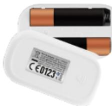
Batérie vymeňte, ak ich kapacita nie je dostatočná a na obrazovke symbol bliká. Inštalujte dva suché články AAA do puzdra batérie podľa indikácie polarity a namontujte kryt batérie.
