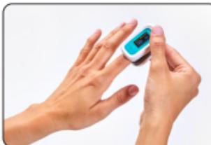
Insérez complètement un doigt dans les parties de mesure de l'oxymètre. Gardez la surface de l'ongle vers le haut et relâchez le clip. Appuyez sur le bouton d'alimentation pour allumer l'oxymètre.
