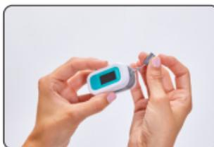
Vous pouvez fixer une lanière à l'appareil pour faciliter le transport de l'oxymètre de pouls. Faites glisser l'extrémité fine de la lanière à travers le support comme sur l'illustration. Tirez fermement l'autre extrémité de la lanière à travers le passant de l'extrémité fine.
