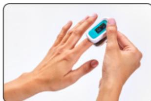
Vložte jeden prst úplne do meracích častí oxymetra. Držte povrch nechtu hore a uvoľnite kliep. Stlačením tlačidla tlačidlo napájania sa oxymeter rozsvieti.
