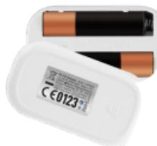
Remplacez les piles lorsque leur capacité est insuffisante et que le symbole clignote dans le processus de surveillance. Installez les deux piles sèches AAA dans le logement de la batterie conformément à l'indication de polarité et montez sur l'écran OLED de deux manières différentes (texte et graphe) et dans quatre directions, comme illustré dans la figure suivante.
